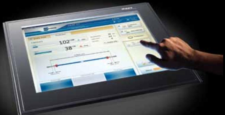
Sensorstruktur. Dadurch verändert sich das Lade- und Entladeverhalten in diesem Bereich der Sensormatrix. Die Position ergibt sich durch die Auswertung und den Vergleich der einzelnen Matrixpositionen. Obwohl das Prinzip auf der Berührung durch einen leitenden Körper mit Erdkontakt beruht, kann durch entsprechende sensorische Abstimmung auch die Bedienung mit Handschuhen ermöglicht werden.
