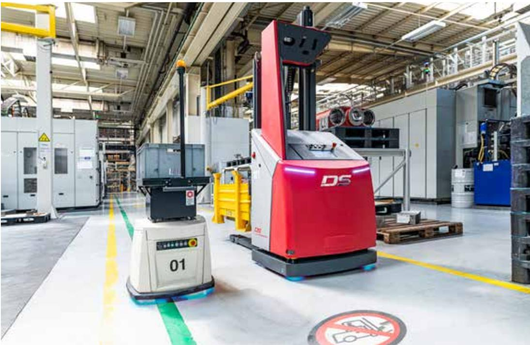
**AMADEUS begegnet dem Kleinlasten-FTF SALLY** von DS Automotion, das per Konturnavigation hauptsächlich Werkzeuge und Messmittel zu den Bearbeitungszentren bringt.
