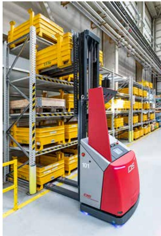
Beim Zwischenlagern der Rohlinge für die Dreh-/Fräsbearbeitung in einem Puffer-Regal kann AMADEUS seine knapp drei Meter Hubhöhe ausspielen.
