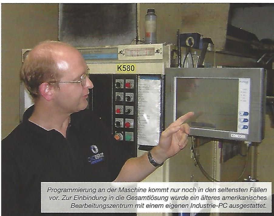
Programmierung an der Maschine kommt nur noch in den seltensten Fällen vor. Zur Einbindung in die Gesamtlösung wurde ein älteres amerikanisches Bearbeitungszentrum mit einem eigenen Industrie-PC ausgestattet.
