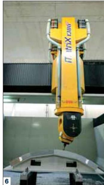
**4-6 Technologisch State of the Art, ermöglicht ein bi-rotatorischer Fräskopf, mit stufenloser C-Achse und Unterschnittbearbeitung durch die A-Achse (Rotation  $\pm 105^\circ$ ), komplexe dreidimensionale Bearbeitungen. Mit Rotationsgeschwindigkeiten bis 100 U/min ist die Matrix 1300 sehr leistungsfähig und vielseitig einsetzbar.**
