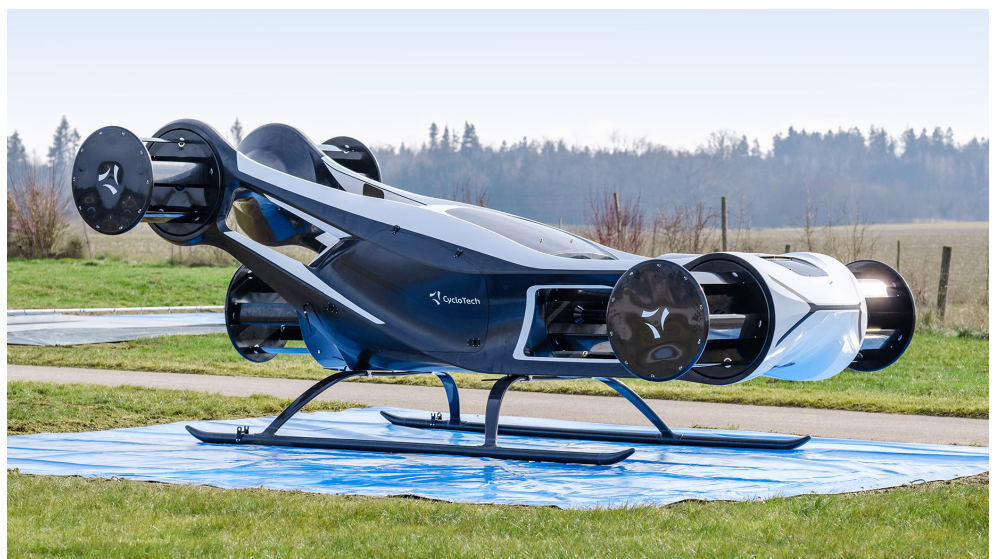
Sechs CycloRotoren in zwei Ausrichtungen verleihen dem BlackBird-Technologie-Demonstrator von CycloTech die volle räumliche Manövrierfähigkeit selbst in engem Luftraum und bei widrigem Wetter.
