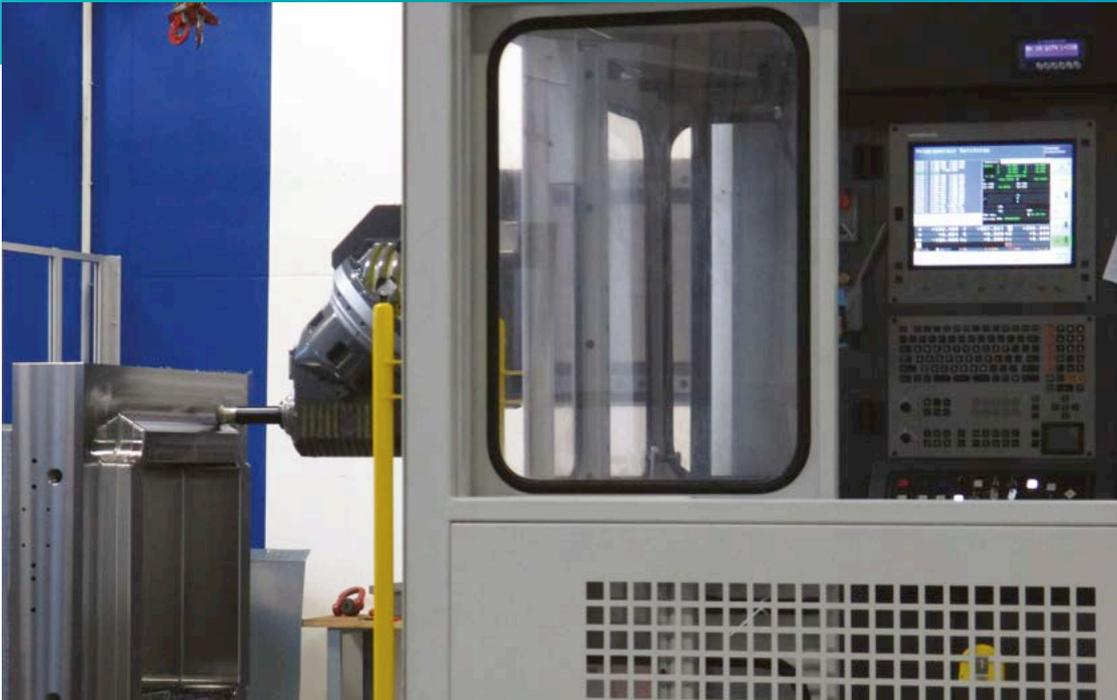
*Die Drahterosion wurde weitgehend durch Hochgeschwindigkeitszerspanung mittels ebenso präziser wie leistungsfähiger Drei- und Fünfachs-Bearbeitungszentren abgelöst.*
