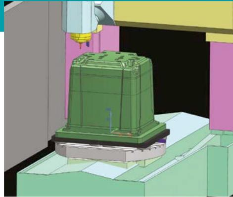
Die Automatisierung formspezifischer Entwicklungsaufgaben wird unterstützt durch eine Produzierbarkeitsüberprüfung, hoch entwickelte Entformungswerkzeuge, eine automatische Kern- und Taschen-erstellung, Schrumpfungsberechnung und -anpassung, Rohre und Anschlüsse für den Kühlkreislauf sowie eine automatische Stücklistengenerierung. Zudem sind Bibliotheken mit Standard-Werkzeugteilen wie Stammwerkzeuge, Auswerferstifte, Schieber und Stößel enthalten.
